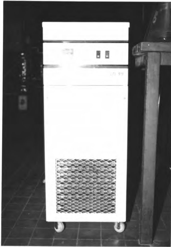
รูปที่ 2-11 เครื่องควบคุมระบบน้ำหล่อเย็น (circulation type handy cooler)
