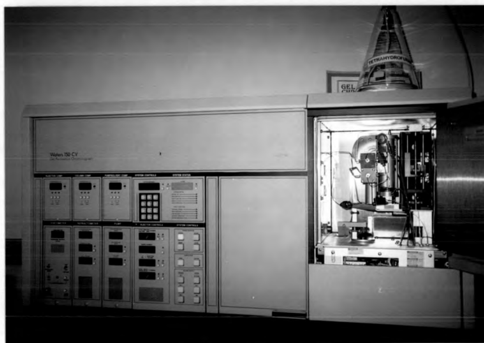
รูปที่ 3.2 Gel Permeation Chromatograph
