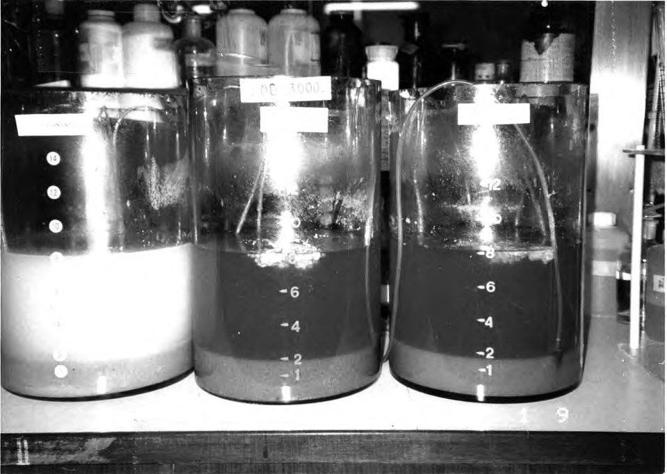
รูปที่ 3.1 ชุดการทดลองในขณะเติมอากาศ ในน้ำเสียห้างสรรพสินค้าโรบินสัน ที่น้ำมันและไขมันเริ่มต้น 792 มิลลิกรัมต่อลิตร
