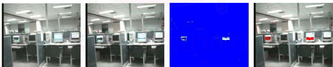
รูปที่ 8 ตัวอย่างที่ระบบทำงานผิดพลาดเนื่องจากการประมาณแบบจำลองฉากหลังขณะที่มีวัตถุที่เคลื่อนที่อยู่ในฉาก (ก) แบบจำลองฉากหลังที่ได้ทำการประมาณไว้ (ข) ภาพรับเข้าปัจจุบัน (ค) กลุ่มของจุดภาพที่ถูกจำแนกให้เป็นฉากหน้า (ง) กลุ่มของจุดภาพที่ถูกจำแนกให้เป็นฉากหลัง
