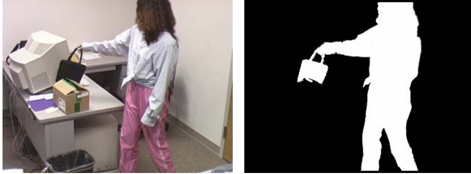
รูปที่ 29 (ก) ภาพด้านเข้าต้นแบบซึ่งนำมาผ่านระบบการแยกส่วนภาพ (ข) ผลการแยกส่วนภาพอ้างอิง ซึ่งทำการแยกส่วนโดยตามมนุษย์และจำแนกโดยใช้การแบ่งในโปรแกรมประยุกต์ด้านการประมวลผลภาพทั่วไป
