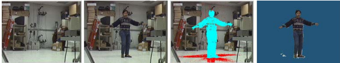
รูปที่ 14 ระเบียบวิธีสามารถจำแนกจุดภาพ และตรวจจับเงาได้อย่างถูกต้อง ถึงแม้การเกิดเงาจะอยู่ภายใต้เงื่อนไของแหล่งกำเนิดแสงหลายแหล่ง
