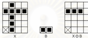
รูปที่ 7 การทำอีโรชัน
