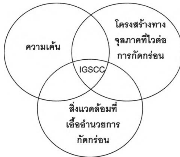
รูปที่ 2.5 แผนภาพแสดง 3 องค์ประกอบที่สำคัญต่อการเกิด IGSCC
