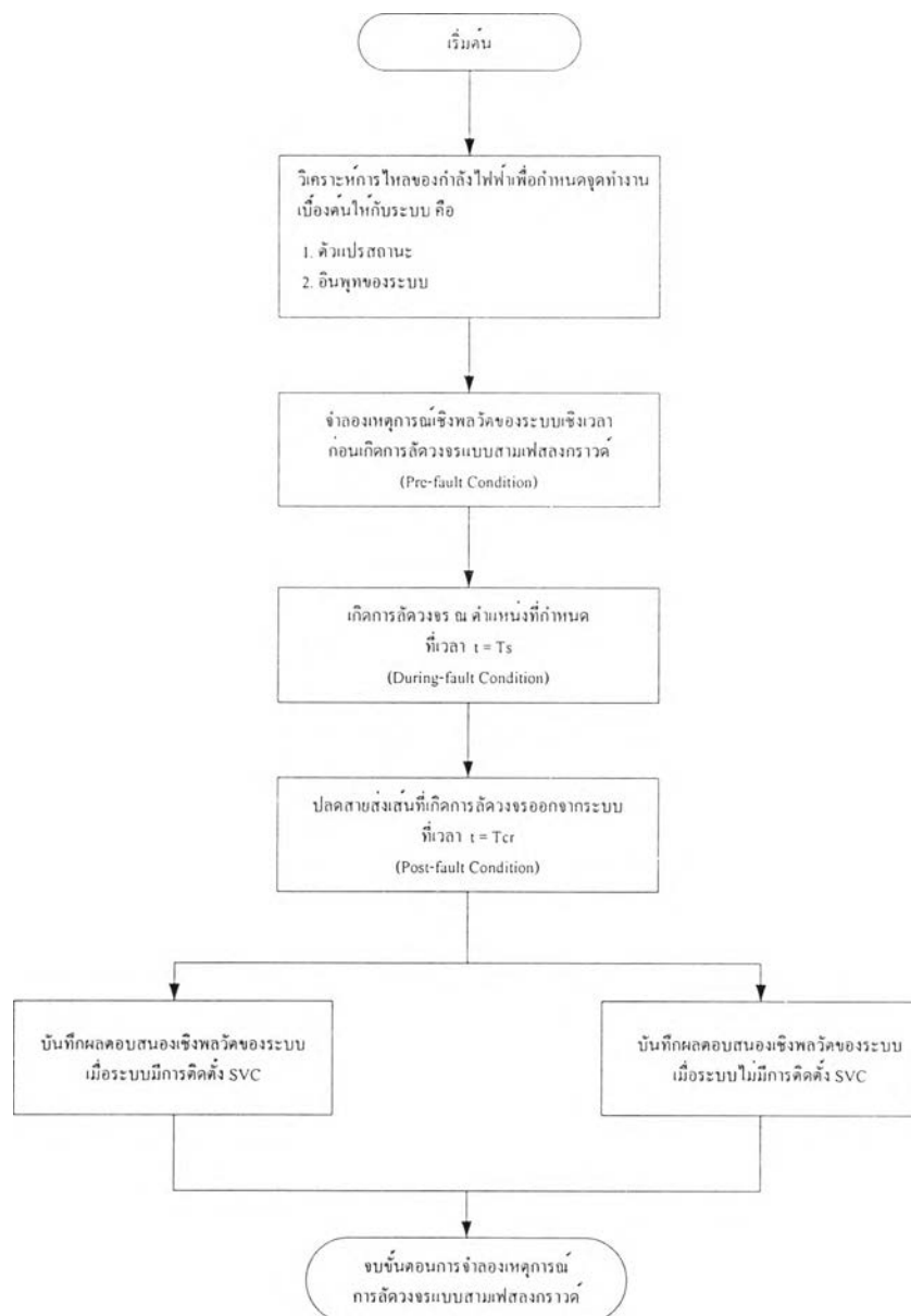
รูปที่ 5.3 แผนผังขั้นตอนการจำลองการเกิดลัดวงจรแบบสามเฟสลงกราวด์บนสายส่ง 1 เส้น
