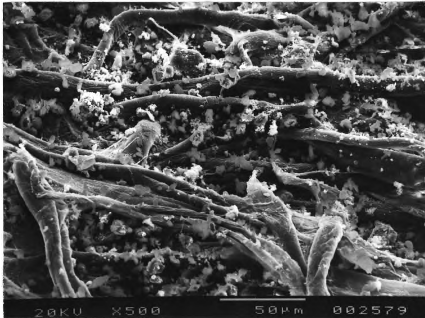
รูปที่ 5.35 ภาพถ่ายจากกล้องจุลทรรศน์อิเล็กตรอนแบบส่องกราด แสดงลักษณะของฝุ่นที่ติดอยู่บนกระดาษกรองเซลลูโลสของตัวอย่างฝุ่นหมายเลข 10 (ตัวอย่างฝุ่นจากบริเวณศูนย์เครื่องมือวิจัยวิทยาศาสตร์และเทคโนโลยี จุฬาลงกรณ์มหาวิทยาลัย) ขนาดกำลังขยาย 500 เท่า
