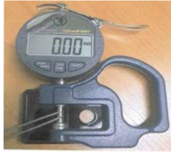
ภาพที่ 3.8 เครื่องวัดขนาดเมล็ดข้าว Length Gauge Terster Tc-118
