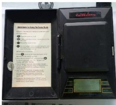
เครื่องชั่งรองรับน้ำหนักขนาด 200 กรัม ตำแหน่งทศนิยม 2 ตำแหน่ง
