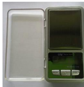
เครื่องชั่งรองรับน้ำหนักขนาด 500 กรัม ตำแหน่งทศนิยม 1 ตำแหน่ง
