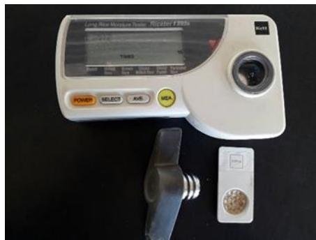
เครื่องทดสอบความชื้นข้าวเปลือก รุ่นเกลียวบิด
