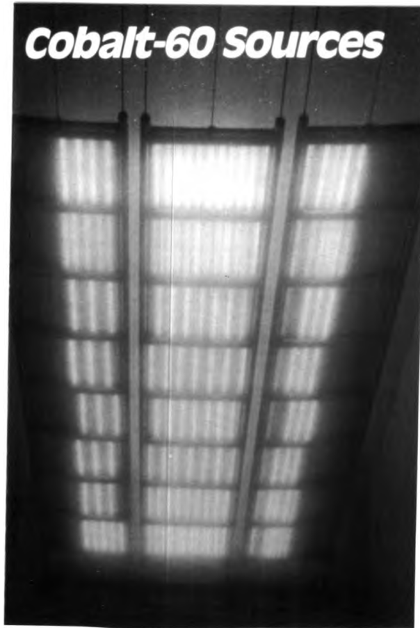
รูปที่ 3.1 แผงแหล่งกำเนิดรังสี โคบอลต์-60 ขณะเก็บไว้ใต้ดิน
