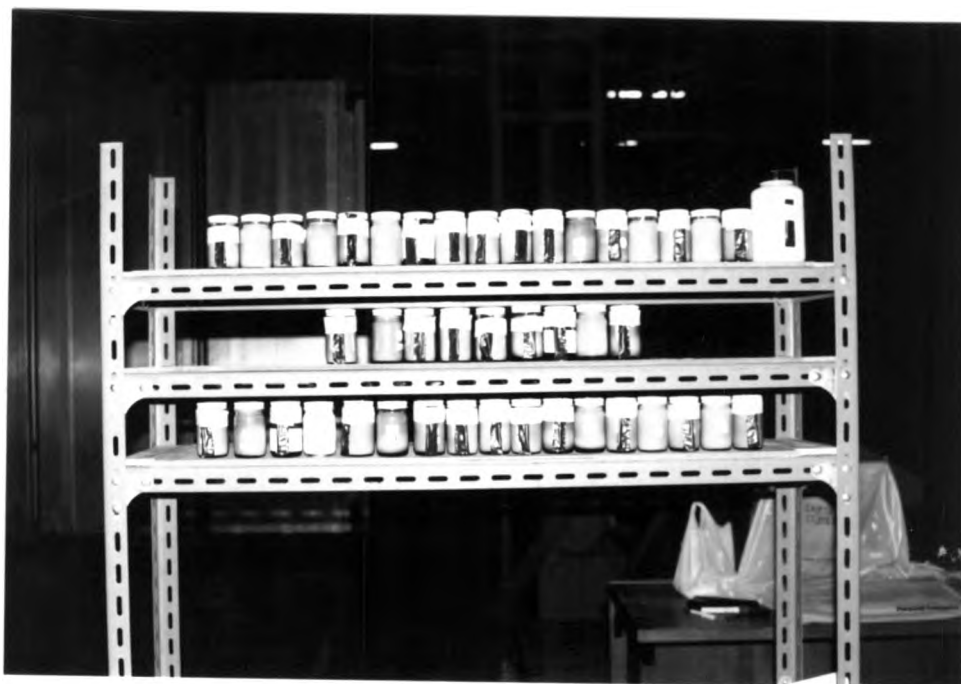
รูปที่ 3.4 ชั้นสำหรับตั้งน้ำยาฉายรังสีก่อนนำไปวางไว้ในห้องฉายรังสี
