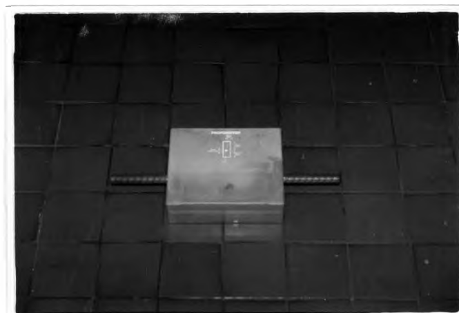
รูปที่ 4.22 ภาพตัวอย่างมาตรฐานเพื่อทดสอบหาตำแหน่ง และขนาดของเหล็กเส้น
