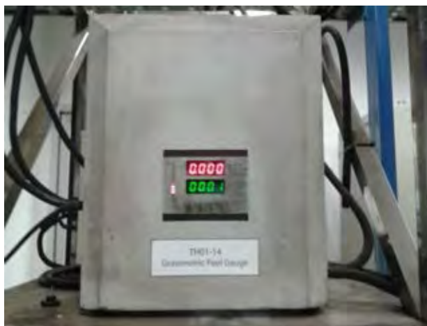
รูปที่ 4 - 6 อุปกรณ์วัดปริมาณเชื้อเพลิงโดยมวล Gravimetric Fuel Gauge
