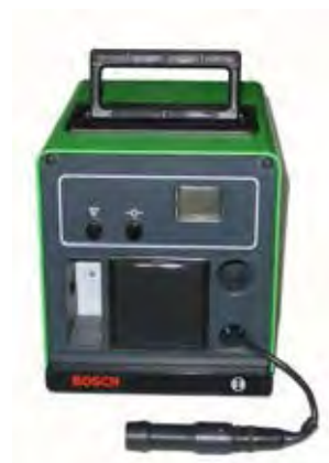
รูปที่ 4 - 14 เครื่องอ่านค่าควัน ค่า รุ่น ETD 020.50
