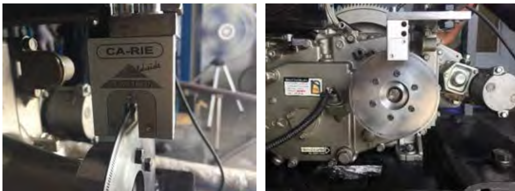
รูปที่ 4 - 21 Crank Angle Encoder ยี่ห้อ DEWETRON รุ่น CA-RIE360
