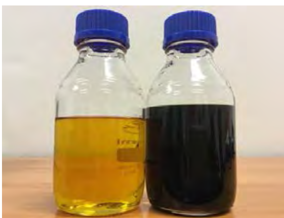
รูปที่ 2 - 6 เชื้อเพลิงดีเซลทั่วไป (ซ้าย) และเชื้อเพลิงดีเซลสังเคราะห์จากขยะพลาสติก (ขวา)
