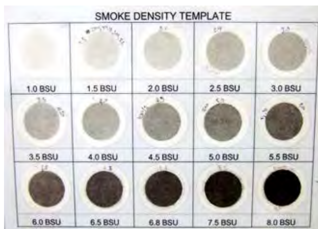
รูปที่ 4 - 15 ตัวอย่างกระดาศกรงที่ใช้ในการวัดค่าควันดำเปรียบเทียบกับ Bosch Unit Number
