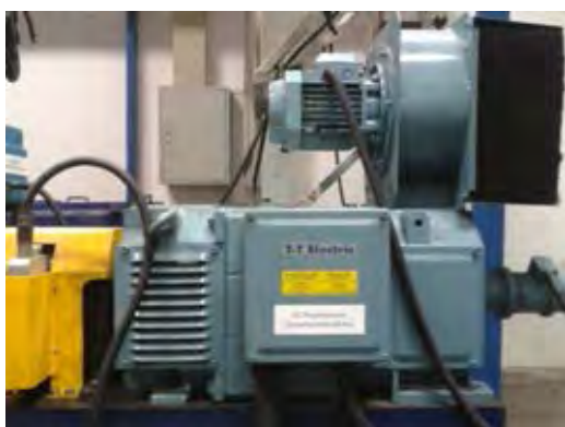
รูปที่ 4 - 4 ไตนาโมมิเตอร์ที่ใช้ทดสอบ ยี่ห้อ T-T Electric
