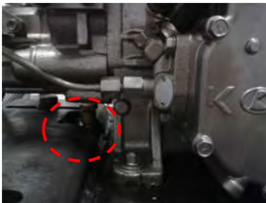
รูปที่ 4 - 8 การติดตั้งเทอร์โมคัปเปิลเพื่อวัดอุณหภูมิน้ำหล่อเย็น
