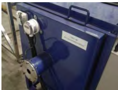
รูปที่ 4 - 11 ถังพักอากาศและการติดตั้ง Orifice
