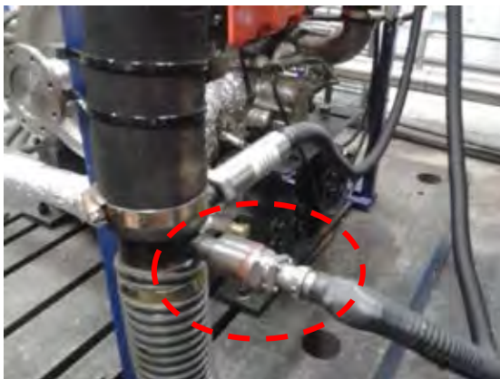
รูปที่ 4 - 7 การติดตั้งเทอร์โมคัปเปิลเพื่อวัดอุณหภูมิอากาศไอดี
