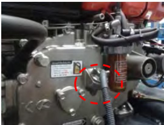
รูปที่ 4 - 9 การติดตั้งเทอร์โมคัปเปิลเพื่อวัดอุณหภูมิน้ำมันหล่อลื่น
