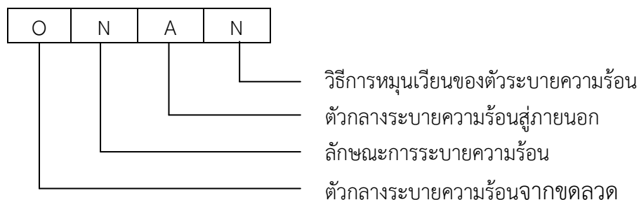
รูปที่ 2.3 สัญลักษณ์การระบายความร้อนของหม้อแปลง
