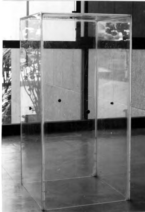
ภาพ ผ.1 ตู้ครอบ (Chamber) เก็บก๊าซที่ถูกลบออกจากนาข้าว
