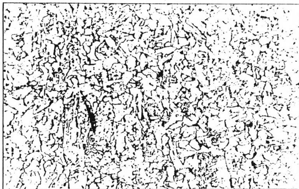
รูปที่ 13D โครงสร้างจุลภาคของ A_{\text{Co-2}} หลังเชื่อม
