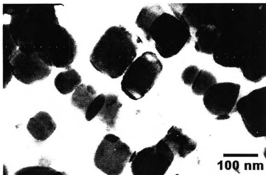
รูปที่ 4.37 โครงสร้างแกมมาไพรมของสลักเกลียวหลังผ่านการอบละลาย 885 (24) ตามด้วยการบ่มแข็ง 680 (20) และทดสอบการคลายความเค้นที่อุณหภูมิ 760 องศาเซลเซียส เป็นเวลา 1,500 ชั่วโมงที่กำลังขยาย 150,000 เท่า ถ่ายภาพโดยกล้องจุลทรรศน์อิเล็กตรอนแบบส่องผ่าน
