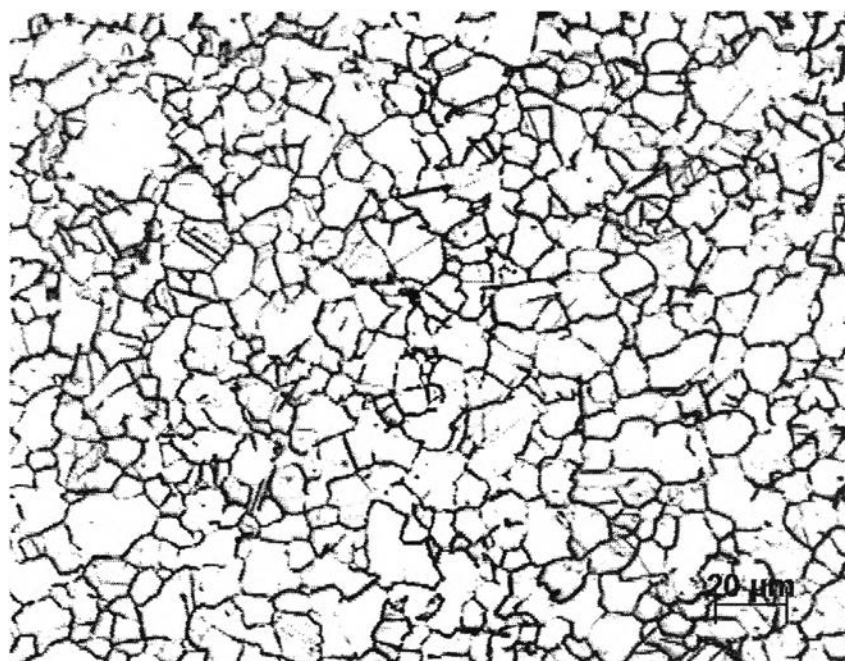
รูปที่ 4.19 โครงสร้างจุลภาคของสลักเกลียวหลังการอบละลาย 885 (24) ตามด้วยบ่มแข็ง 680 (20) และทดสอบการคลายความเค้นที่อุณหภูมิ 650 องศาเซลเซียส เป็นเวลา 500 ชั่วโมง ขนาดเกรน ASTM, G11 ที่กำลังขยาย 200 เท่า ถ่ายภาพโดยกล้องจุลทรรศน์แบบแสง
