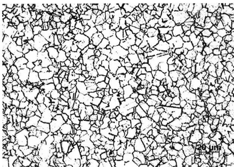
รูปที่ 4.21 โครงสร้างจุลภาคของสลักเกลียวหลังผ่านการอบละลาย 885 (24) ตามด้วยบ่มแข็ง 760 (20) และทดสอบการคลายความเค้นที่อุณหภูมิ 650 องศาเซลเซียส เป็นเวลา 2,000 ชั่วโมง ขนาดเกรน ASTM, G11 ที่กำลังขยาย 200 เท่า ถ่ายภาพโดยกล้องจุลทรรศน์แบบแสง
