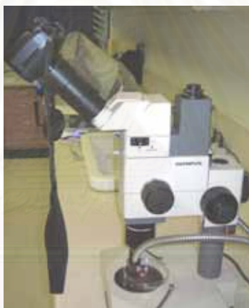
ภาพที่ 7 แสดงการใช้กล้องถ่ายภาพรูปดิจิทัลเชื่อมต่อกับกล้องจุลทรรศน์สเตอริโอ
