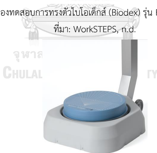
รูปที่ 38 เครื่องทดสอบการทรงตัวไบโอเด็กส์ (Biodex) รุ่น Balancesystem™SD ที่มา: Freedom Physical Therapy, n.d.
