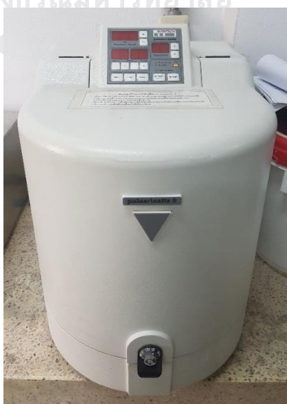
ภาพที่ 1 เครื่องบดแบบลูกบอลเซอร์โคเนีย (zirconia planetary ball mill)
