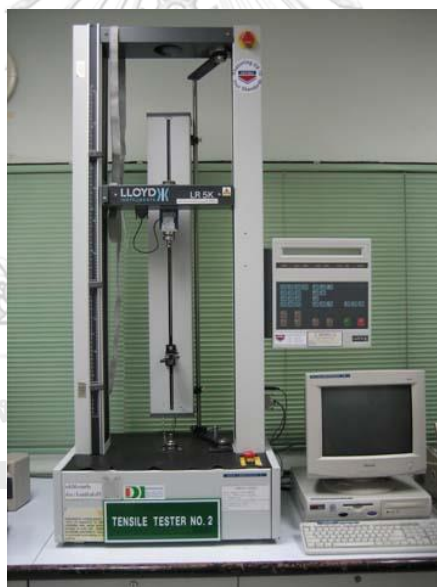
ภาพที่ 12 เครื่องทดสอบความทนแรงอัด (Universal Testing Machine)
