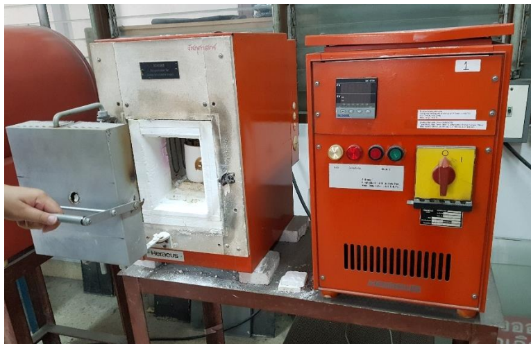
ภาพที่ 5 เตาหลอมอุณหภูมิสูง (high temperature furnace)
