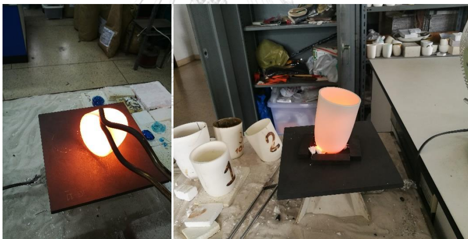
ภาพที่ 6 เบ้าหลอมอะลูมินาที่นำออกจากเตาเพื่อลดอุณหภูมิ
