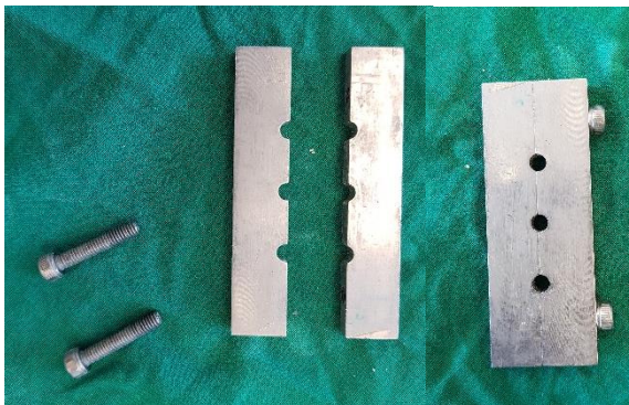
ภาพที่ 11 แม่พิมพ์เหล็กไร้สนิมขนาดเส้นผ่านศูนย์กลาง 4 มิลลิเมตร สูง 6 มิลลิเมตร
