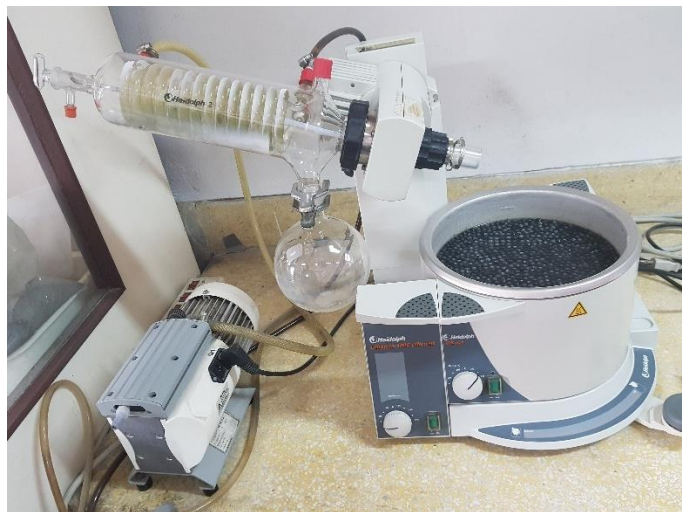
ภาพที่ 2 เครื่องกลั่นระเหยแบบหมุนภายใต้สุญญากาศ (rotary evaporator)
