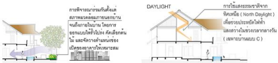
ภาพที่ 2.1 การวางตำแหน่งอาคารให้ถูกทิศทาง
