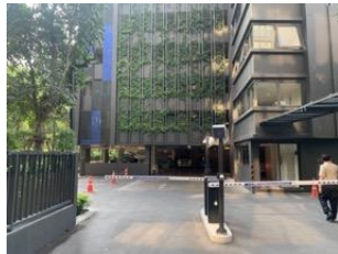
อาคารจอดรถ พบสวนแนวตั้งแบบระแนงบังแดดไม้ เลื้อย
