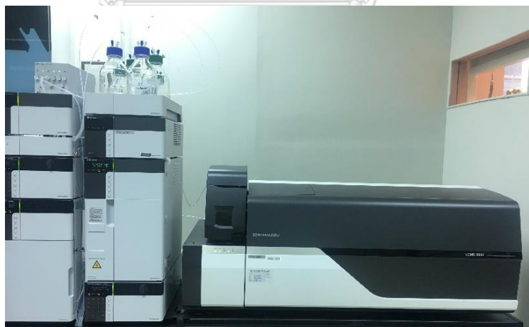
ภาพที่ 5 แสดงเครื่อง liquid chromatography mass spectrometer
