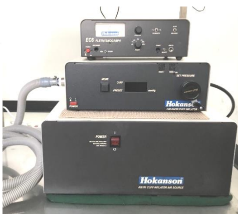
ภาพที่ 1 เครื่อง venous occlusion strain gauge plethysmography และ rapid cuff inflation สำหรับใช้วัดการไหลของเลือดบริเวณแขน
