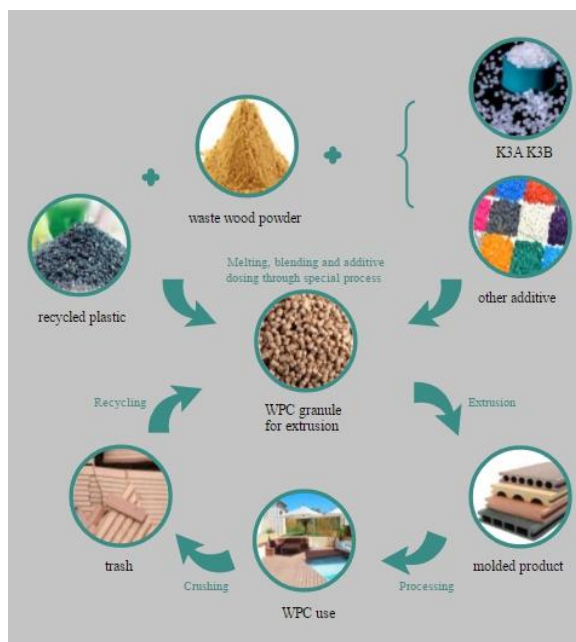
ภาพที่ 12 ภาพกระบวนการผลิต WPC (Watsaduniyom, 2020)
