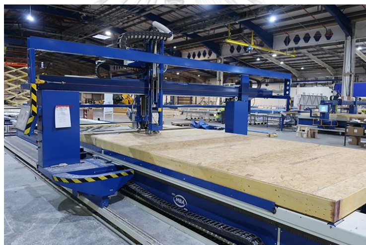
ภาพภายในโรงงานผลิตแผ่นโครงสร้างแซนวิช โดยผิวเป็นไม้อัด
