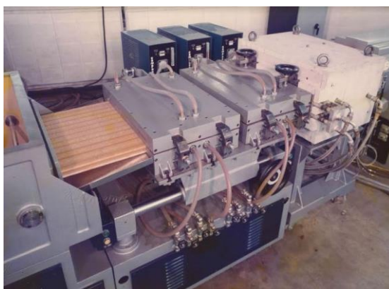
ภาพที่ 13 เครื่องอัดขึ้นรูปสำหรับไม้สังเคราะห์ WPC เครื่องแรกของโลก (Covema, 2021)
