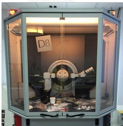
รูปที่ 3.7 เครื่องวิเคราะห์การเลี้ยวเบนรังสีเอกซ์ของ Bruker รุ่น D8 Advance
