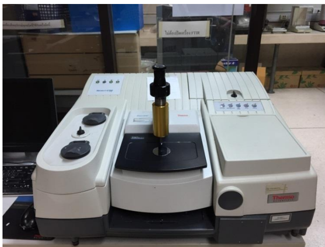
รูปที่ 3.8 เครื่องฟูเรียร์ทรานส์ฟอร์มอินฟราเรดสเปกโทรโฟโตมิเตอร์ของ Thermo scientific รุ่น Nicolet 6700
