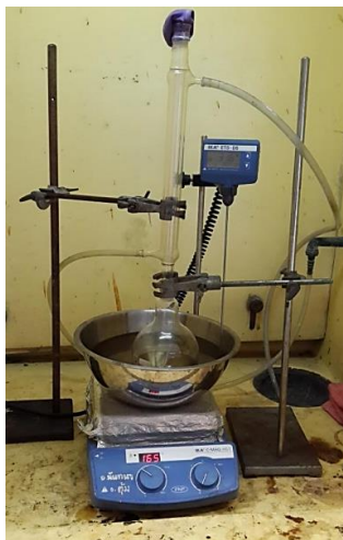
รูปที่ 3.3 การรีฟลักซ์พอลิบิวทิลีนซึกซิเนตกราฟต์ด้วยไกลซีดีลเมทาคริเลต
