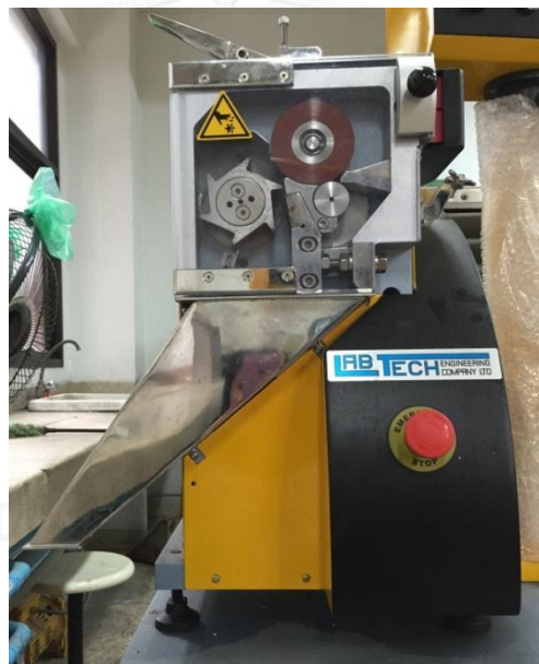
รูปที่ 3.2 เครื่องตัดเม็ดพลาสติกของ Labtech Engineering รุ่น LZ-80/VS
