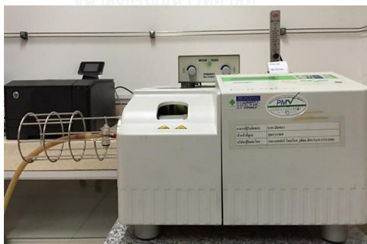
รูปที่ 3.10 เครื่องวิเคราะห์น้ำหนักภายใต้ความร้อนของ Mettler Toledo รุ่น TGA/SDTA851 e
