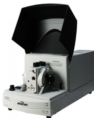
รูปที่ 3.15 เครื่องทดสอบการซึมผ่านของไอน้ำของ MOCON รุ่น PERMATRAN-W ® 3/33 [45]
