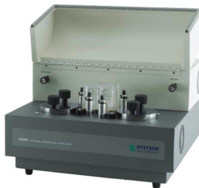
รูปที่ 3.16 เครื่องทดสอบการซึมผ่านของก๊าซออกซิเจนของ SYSTECH Illinois รุ่น 8000 [46]
