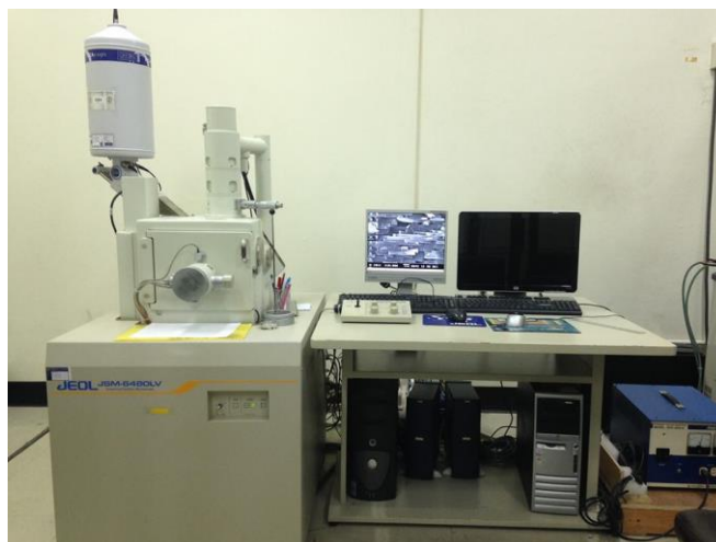
รูปที่ 3.9 กล้องจุลทรรศน์อิเล็กตรอนแบบส่องกราดของ JEOL รุ่น JSM-6400LV
