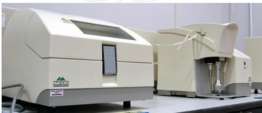
รูปที่ 3.5 เครื่องวิเคราะห์ขนาดอนุภาคซิลิกาของ Malvern รุ่น Mastersizer 2000
