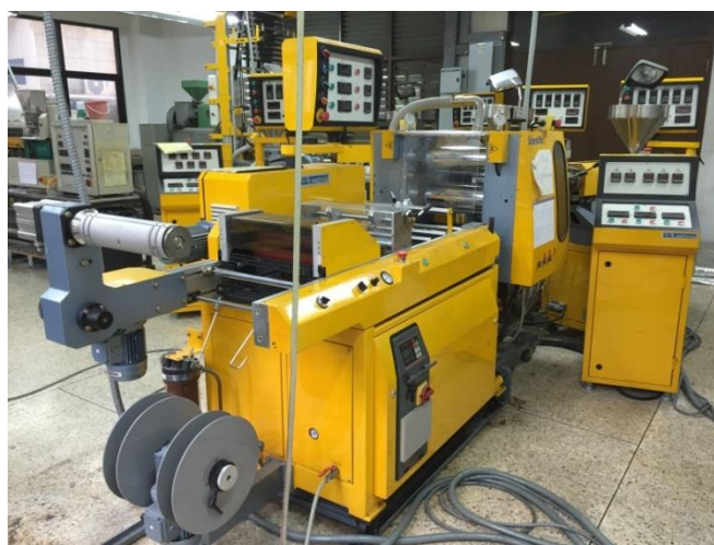
รูปที่ 3.4 เครื่องรีดหล่อฟิล์มของ Labtech Engineering รุ่น LCR-300HDCO-EX
