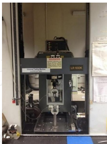
รูปที่ 3.12 เครื่องทดสอบอเนกประสงค์ของ LLOYD รุ่น LR100K
