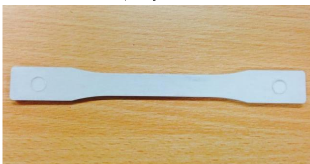
รูปที่ 3.6 ชิ้นทดสอบสมบัติความทนแรงดึง
