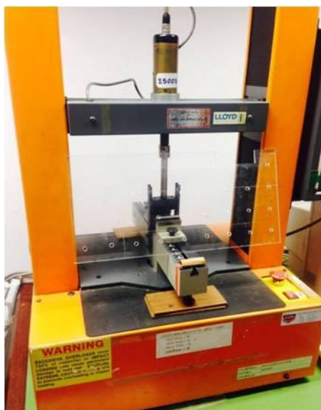
รูปที่ 3.9 เครื่องทดสอบความทนแรงดัดโค้ง
