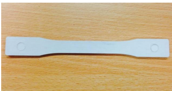
รูปที่ 3.16 ชิ้นทดสอบการย่อยสลายทางชีวภาพโดยการฝังดิน
