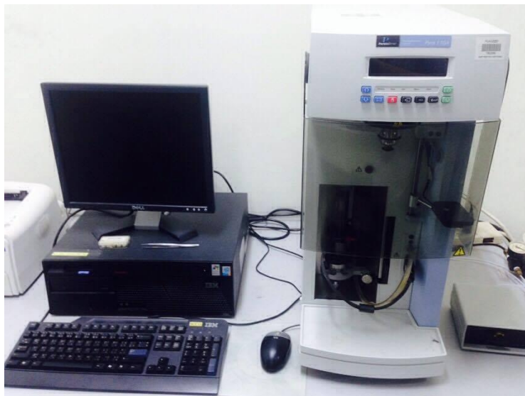
รูปที่ 3.11 เครื่องวิเคราะห์น้ำหนักภายใต้ความร้อน
