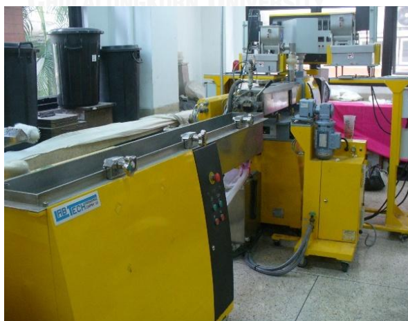
รูปที่ 3.2 เครื่องอัดรีดแบบเกลียวคู่
