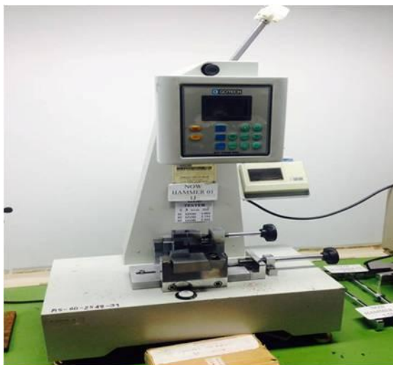
รูปที่ 3.5 เครื่องทดสอบความทนแรงกระแทก
