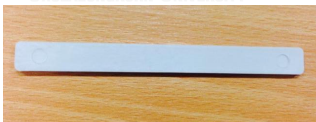
รูปที่ 3.8 ชิ้นทดสอบความทนแรงดัดโค้ง
