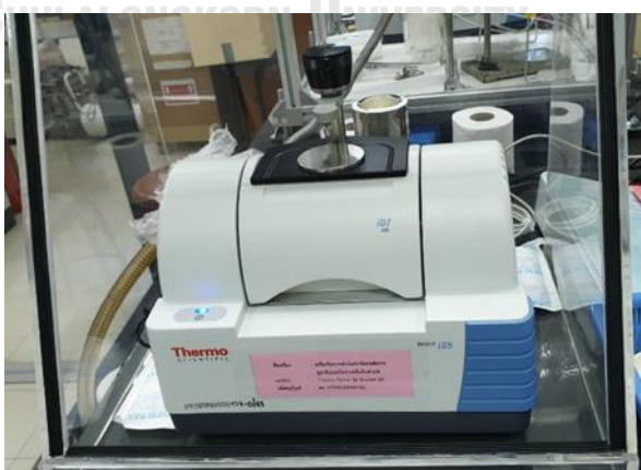
รูปที่ 3.5 เครื่อง Fourier transform infrared spectrophotometer บริษัท Thermo Fisher รุ่น Spectrum One
