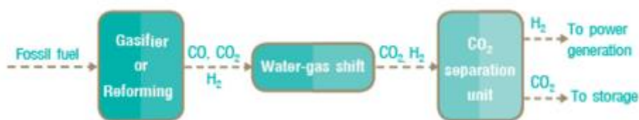
รูปที่ 1 การดักจับแก๊สคาร์บอนไดออกไซด์ก่อนการเผาไหม้ [14] [15]
