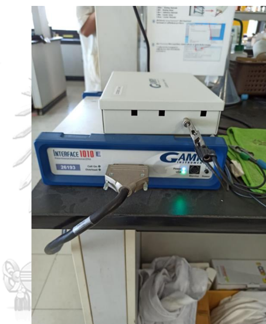
ภาพที่ 3. 5 การทดสอบสมบัติไฟฟ้าเคมีโดยใช้เครื่อง Potentiostat/Galvanostat
