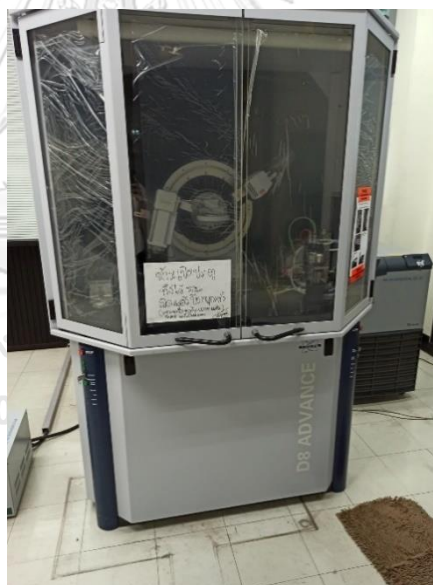
ภาพที่ 3. 3 การวิเคราะห์โครงสร้างผลึกด้วยเครื่องวิเคราะห์การเลี้ยวเบนรังสีเอกซ์
