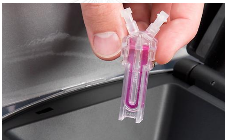
รูปที่ ๑. 2 ภาพขณะบรรจุตัวอย่างสำหรับวัดค่าศักย์เซต้า
