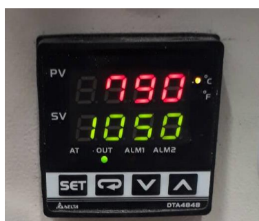
ภาพที่ 3.4 เครื่องแปลงสัญญาณเพื่อแสดงผลอุณหภูมิ
