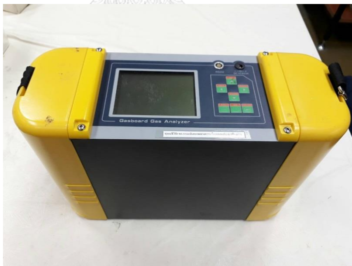
ภาพที่ 3.5 เครื่องวิเคราะห์ก๊าซ (Portable infrared Coal gas Analyzer)
