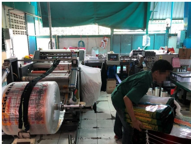
รูปที่ 3.12 เครื่องตัดกระสอบพลาสติกสานแบบเคลือบและเย็บ
