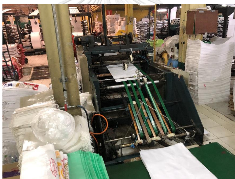
รูปที่ 3.13 เครื่องตัดกระสอบพลาสติกสาน
