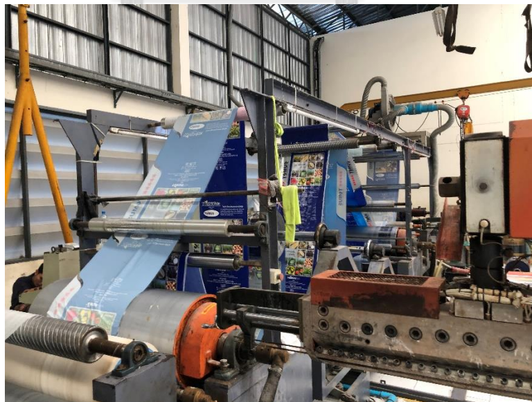
รูปที่ 3.9 เครื่องเคลือบกระสอบ
