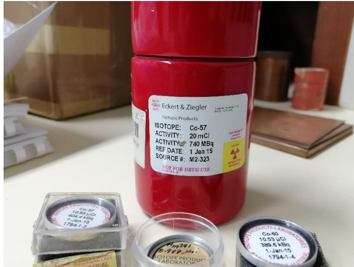
ภาพที่ 3.13 แหล่งกำเนิดรังสีแกมมาสำหรับวิเคราะห์คุณภาพห้วงรังสี
