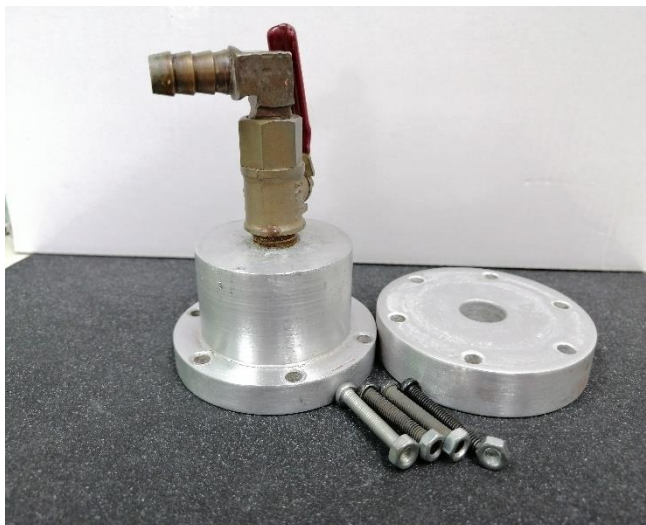
ภาพที่ 3.10 ชุดอุปกรณ์สำหรับเชื่อมต่อหลอดแก้วควอทซ์และระบบสุญญากาศ
