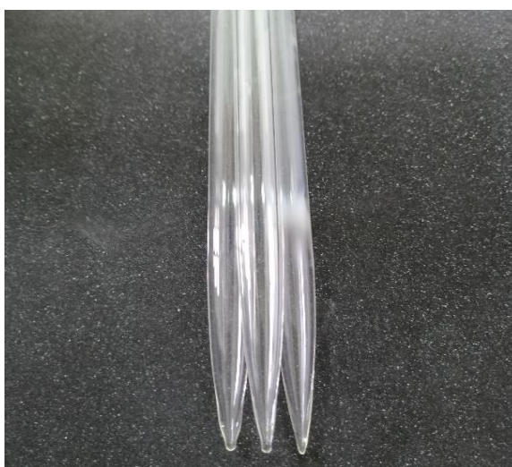
ภาพที่ 3.9 หลอดแก้วควอทซ์สำหรับใช้เป็นภาชนะปลุกผลึก
