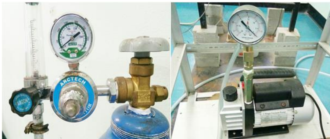
ภาพที่ 3.8 ระบบปั๊มสุญญากาศและระบบควบคุมก๊าซอาร์กอน
