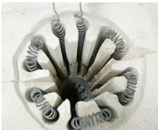
ภาพที่ 3.6 เตาหลอมที่มีขดลวดให้ความร้อนภายใน
