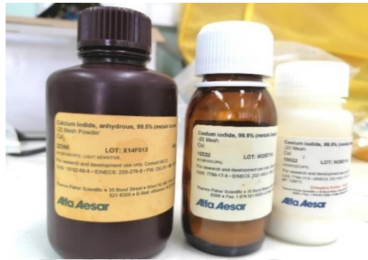
ภาพที่ 3.1 สารตั้งต้น CsI, CaI_2 และ TlI ที่ใช้ในการปลูกผลึก
