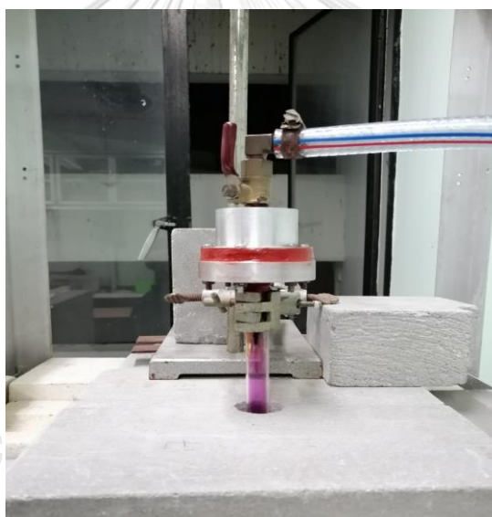
ภาพที่ 4.5 ภาชนะปลูกผลึกขณะอยู่ในเตาหลอม
