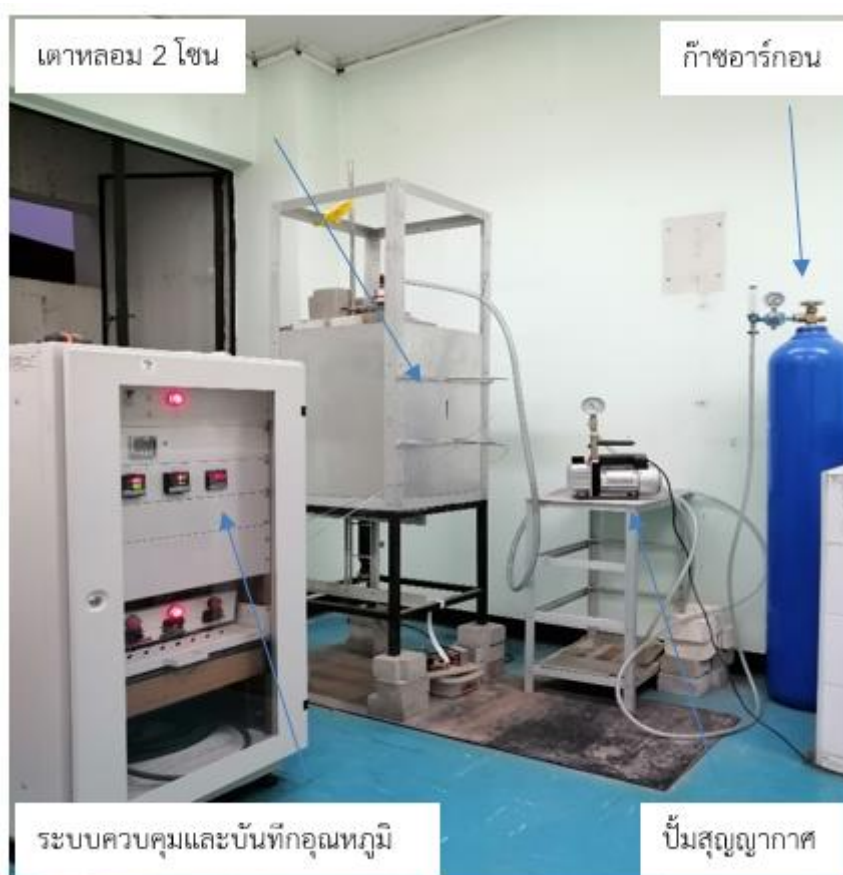
ภาพที่ 3.3 ระบบเตาปลุกผลึกแบบบริดจ์แมน-สต็อกบาร์เกอร์
