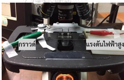
รูปที่ ค.3 การต่อวงจรไฟฟ้ากับระบบของไหลจุลภาค.
