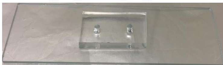
รูปที่ ก.4 ประกอบ PDMS กับกระจกสไลด์.
