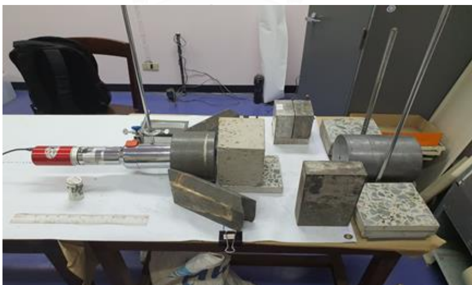
รูปที่ 5 การทดสอบหาค่าสัมประสิทธิ์การลดทอนรังสีของคอนกรีตด้วยรังสีแกมมา
