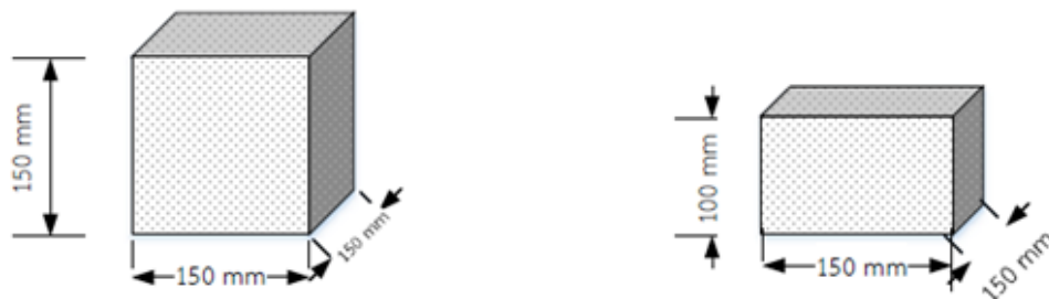
รูปที่ 7 ตัวอย่างที่จะใช้ในการทดสอบทางรังสี
