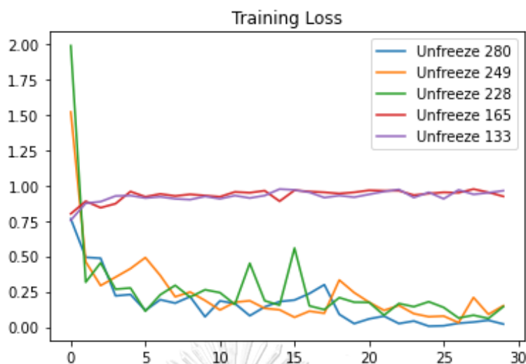
รูปที่ 42 ความสูญเสียของแบบจำลองการเรียนรู้แบบถ่ายโอน InceptionV3 จากการละทิ้งการตรึงที่ ชั้นต่างๆ ในขั้นตอนการฝึกสอนแบบจำลอง
