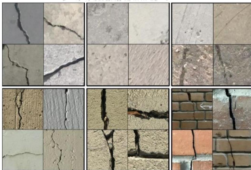
รูปที่ 9 ตัวอย่างชุดข้อมูลฝึกสอน และชุดข้อมูลทดสอบในงานตรวจจับรอยร้าวในอาคารจากรูปภาพ
