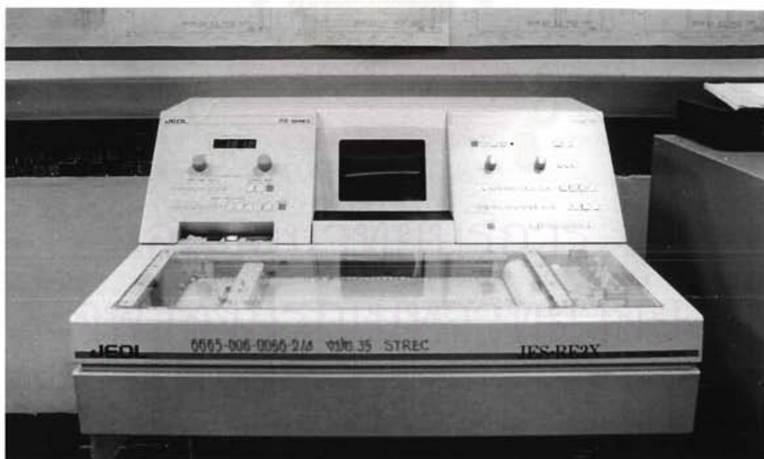
รูปที่ 3.4 แสดงแผงควบคุมและปรับตั้งค่าการวัดของเครื่องอิเล็กตรอนสปีนเรโซแนนซ์สเปกโตรเมตรี
