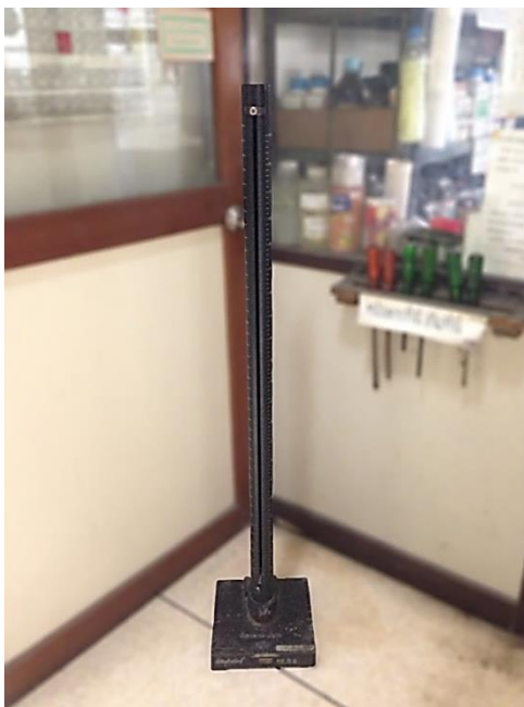
รูปที่ 3.13 เครื่องทดสอบแรงกระแทก (tubular Impact tester)
