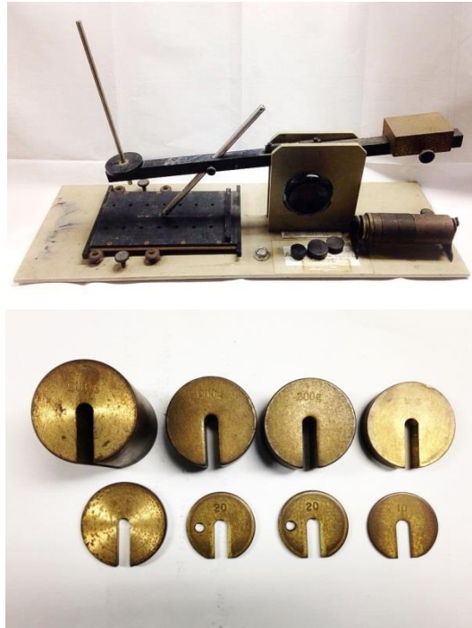
รูปที่ 3.9 เครื่องทดสอบการขูดขีดและดื่มน้ำหนัก
