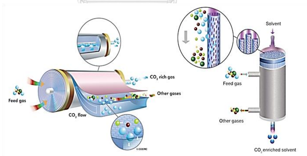
รูปที่ 2.3 การดักจับคาร์บอนไดออกไซด์ด้วยการใช้เมมเบรน [9]
