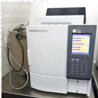
รูปที่ 3.12 เครื่องแก๊สโครมาโตกราฟีประกอบด้วยตัวตรวจวัดชนิดสภาพนำความร้อน Shimadzu รุ่น GC-2014
