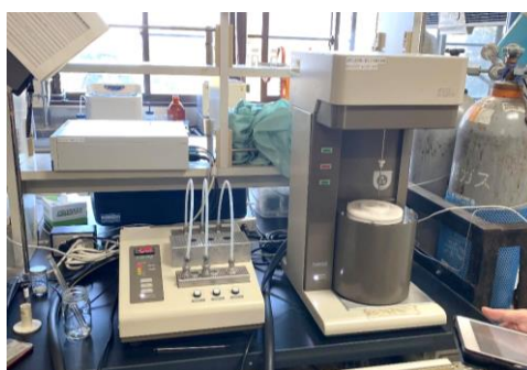
รูปที่ 3.2 เครื่องทดสอบการดูดซับและการคายแก๊สไนโตรเจน ยี่ห้อ MicrotracBEL รุ่น Belsorp mini II
