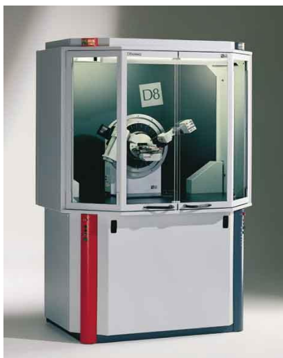
รูปที่ 3.4 เครื่องเอกซเรย์ดิฟแฟลกชันสเปคโตรสโคปี [35]
