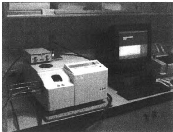
รูปที่ 3.6 เครื่อง Thermogravimetric Analysis (TGA) (METTLER TOLEDO®, SDTA 851e)
