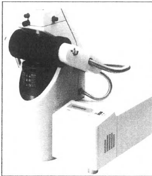
รูปที่ 3.8 เครื่อง Dynamic Mechanical Analyzer (DMA) METTLER TOLEDO DMA861 e
