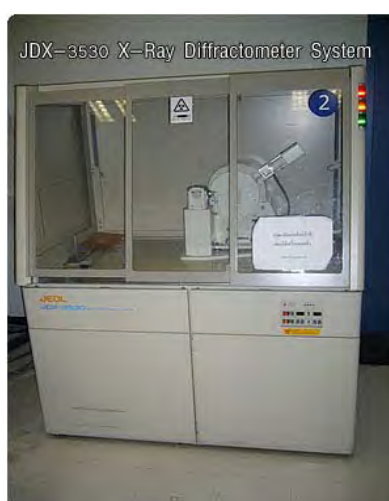
รูปที่ 3.4 เครื่อง X-Ray Diffractometer รุ่น JDX-3530 ของบริษัท JEOL
