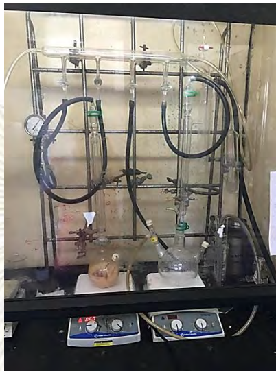
รูปที่ 2.1 การสังเคราะห์ Se-doped mesoporous silica ที่ต่อเข้ากับ Schlenk line ภายใต้ N_2
