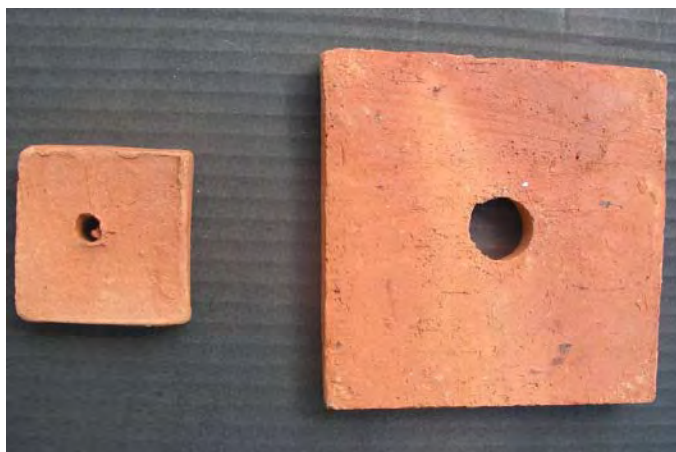
รูปที่ 1 แผ่นกระเบื้องที่ใช้ในการลงเกาะของปะการัง ขนาด 5x5 และ 10x10 ตารางเซนติเมตร
