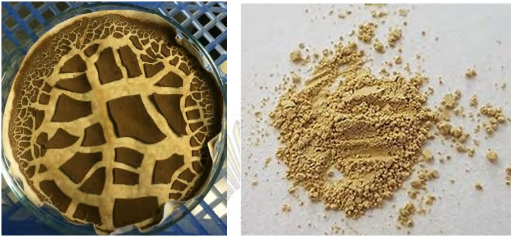
รูปที่ 3.9 ซิลิกาที่ผ่านการตัดแปรด้วยออกไซด์ของเหล็กและทองแดงก่อนบด (a) และหลังบด (b)
