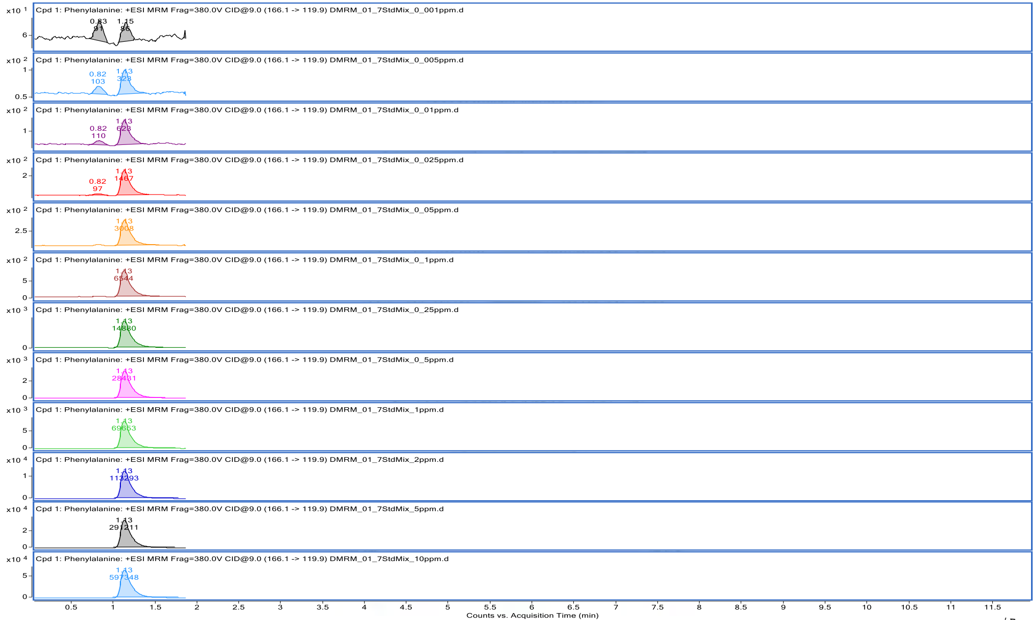
รูป ข.1 โครมาโทแกรมของสารละลายมาตรฐาน phenylalanine โดย product ion m/z = 119.9 ความเข้มข้น 0.001 – 10 มิลลิกรัมต่อลิตร
