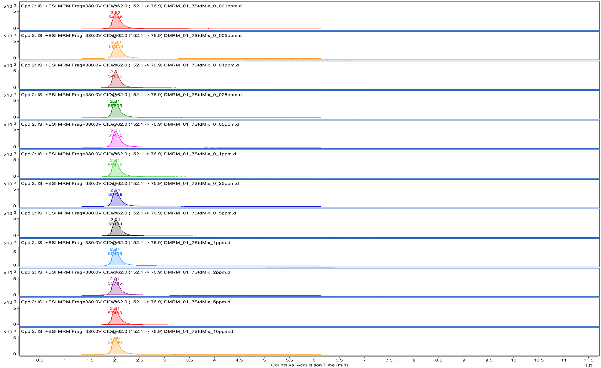
รูป ข.2 โครมาโทแกรมของสารละลาย internal standard โดย product ion m/z = 76.9 ความเข้มข้น 2 มิลลิกรัมต่อลิตร
