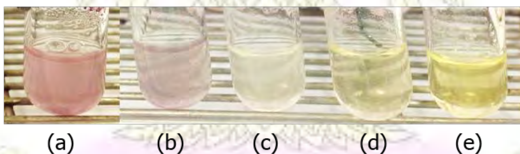
รูปที่ 3.7 อนุภาคนาโนทองคำที่เสถียรด้วยไคโตซานปริมาณแตกต่างกัน
