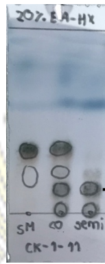
รูปที่ 3.32 TLC แสดงผลิตภัณฑ์จากปฏิกิริยาการสังเคราะห์สาร 6
