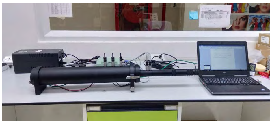
รูปที่ 2.3 แสดงภาพการจัดเครื่องทดสอบค่าสัมประสิทธิ์การดูดซับเสียงของชิ้นงานท่อเล็ก
