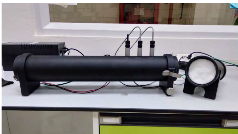
รูปที่ ๗7 ภาพขั้นตอนการวัดค่าสัมประสิทธิ์การดูดซับเสียงด้วยท่ออินพีแดนซ์
