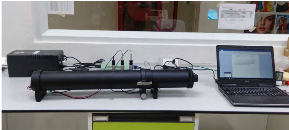
รูปที่ 2.2 แสดงภาพการจัดเครื่องทดสอบค่าสัมประสิทธิ์การดูดซับเสียงของชิ้นงานท่อใหญ่
