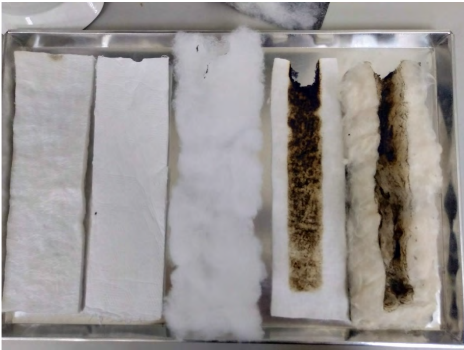
รูปที่ ๙ ภาพชิ้นงานหลังจากนำไปทดสอบการลามไฟ
