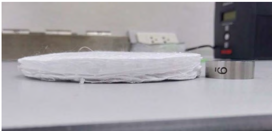
รูปที่ 2.1 รูปชิ้นงานที่ขึ้นรูปแล้วได้ความหนา 9 มม.
