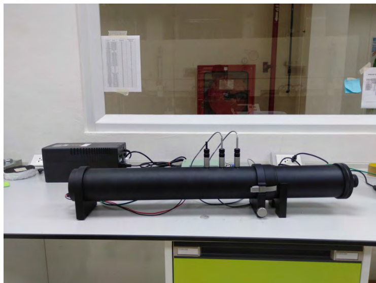
รูปที่ ผ2 ภาพท่ออินพีแดนซ์ เครื่องมือสำหรับใช้ทดสอบค่าการดูดซับเสียงของวัสดุ
