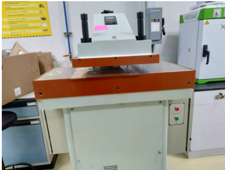
รูปที่ ผ1 ภาพเครื่องไฮดรอลิกเพรส เครื่องมือสำหรับการตัดชิ้นงาน
