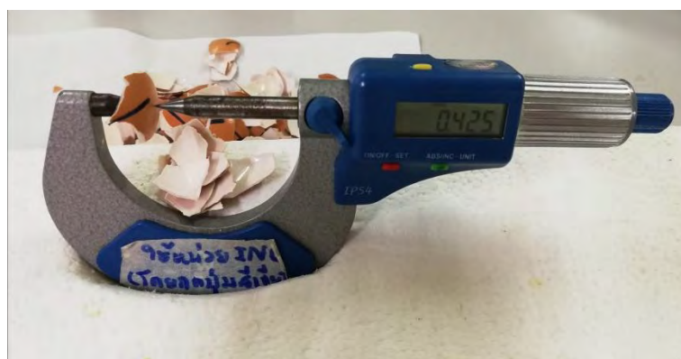
รูปที่ 3.7 แสดงเครื่อง digital micrometer ขณะทำการวัดความหนาของเปลือกไข่ไก่
