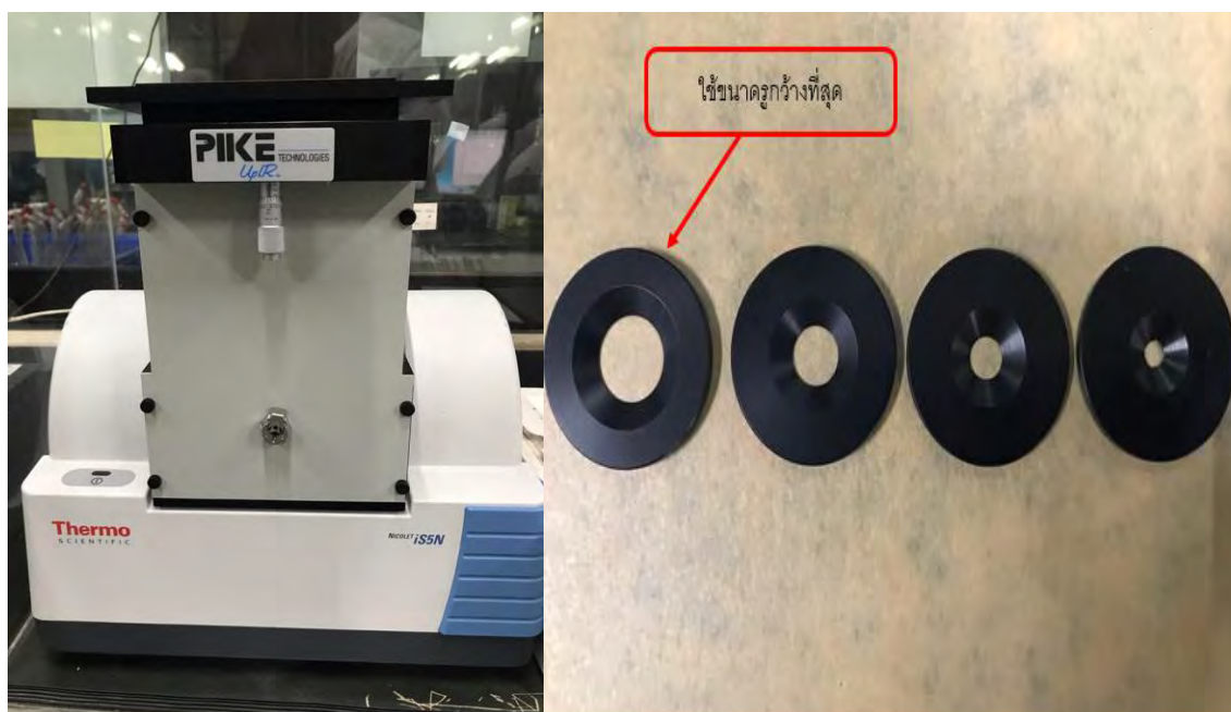
รูปที่ 3.3 แสดงเครื่องเนียร์อินฟราเรดสเปกโตรมิเตอร์โมเดล Nicolet iS5N ในรูปแบบสะท้อน โดยใช้
